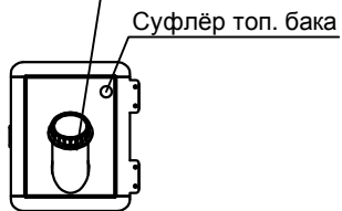
П2 Устройство заправки топлива для дополнительного бака . Заливная горловина
